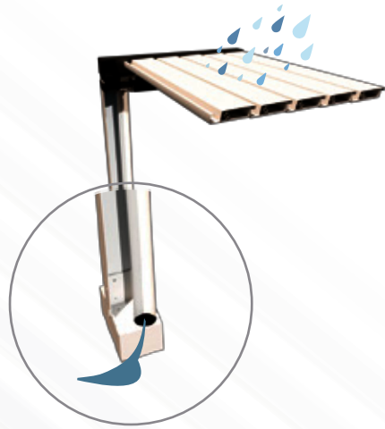
Desagüe por solera
